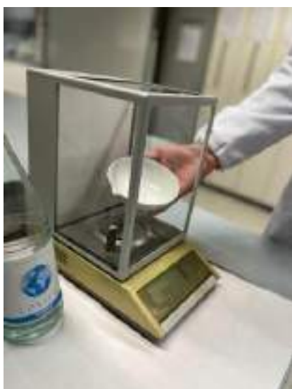
Misura della massa della capsula con con bilancia analitica
