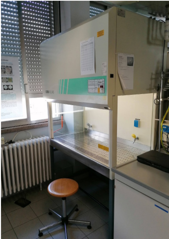
La cappa a flusso laminare utilizzata per le semine
